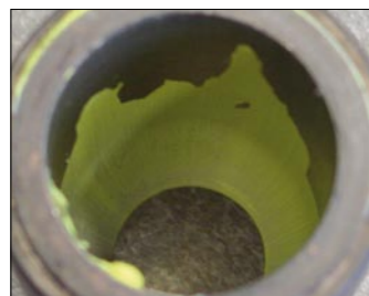
Figuur 5: Plate-out in een blaasvorm-toepassing. Kleurstofuitstoting van EA10 (links) ten opzichte van RPC10 aan de rechterkant.
